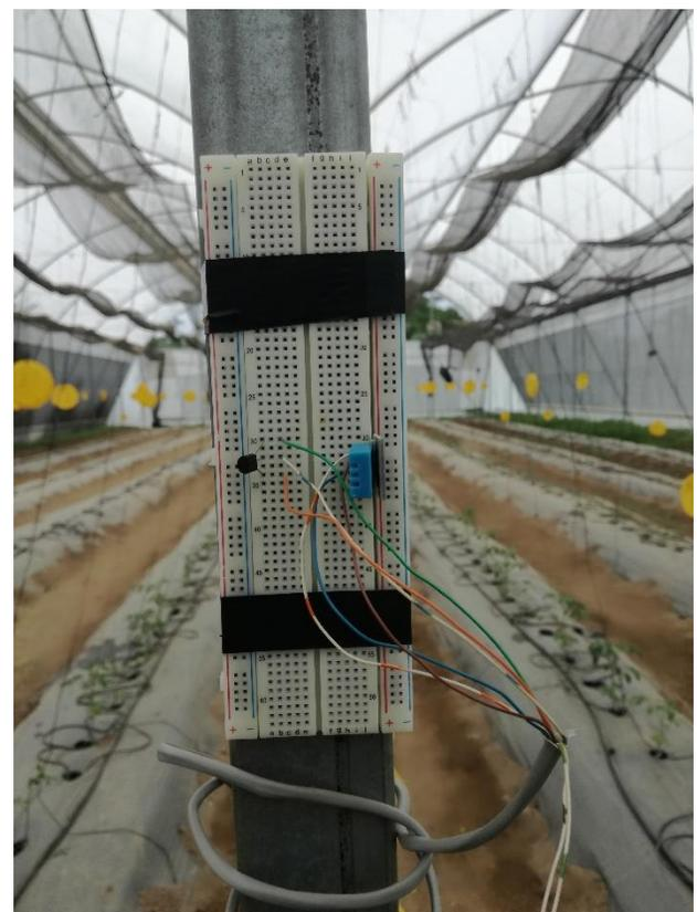
**Anexo 1** Montaje de Sensores en el protoboard
